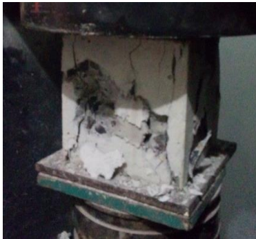
Gambar 11. Pola retak kolo (columnar) pada pengujian kuat tekan kubus beton dalam penelitian
