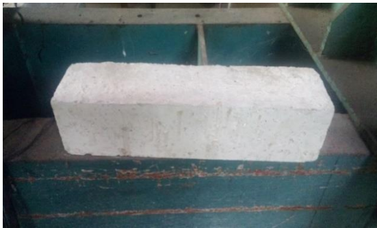
Gambar 6. Benda Uji Berbentuk Balok 40cm x 10cm x 10cm
