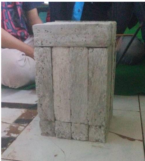
Gambar 7. Benda Uji Berbentuk Balok 16cm x 4cm x 4cm
